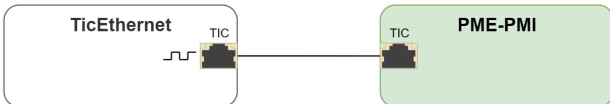
Figure 1 Connection au compteur avec TIC non modulée
